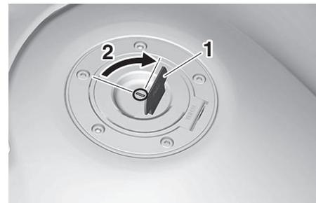
1. Cubierta de la cerradura del tapón del depósito de gasolina
