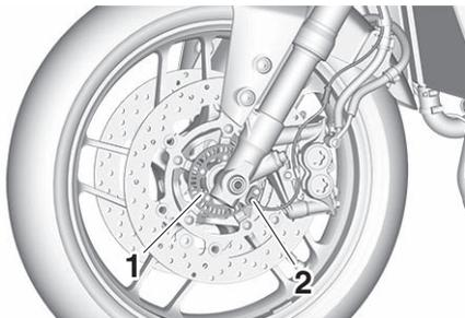
1. Rotor del sensor de la rueda delantera
